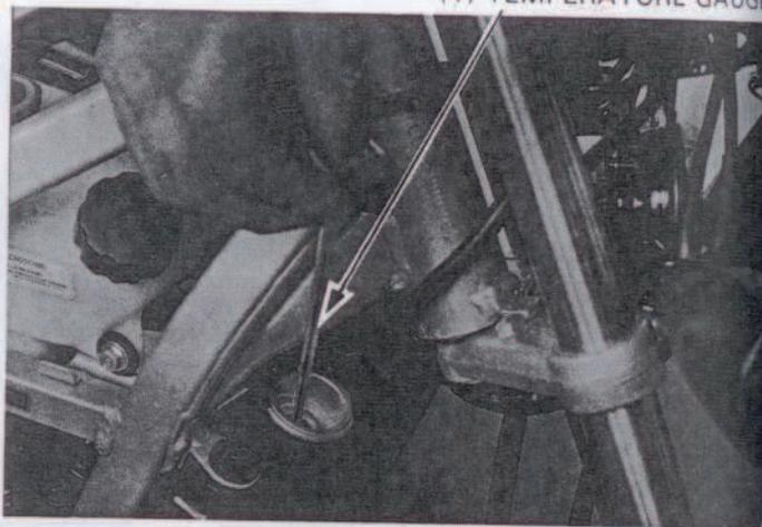
Avviare il motore e misurare la resistenza del sensore della temperatura a diverse temperature del liquido di raffreddamento.
